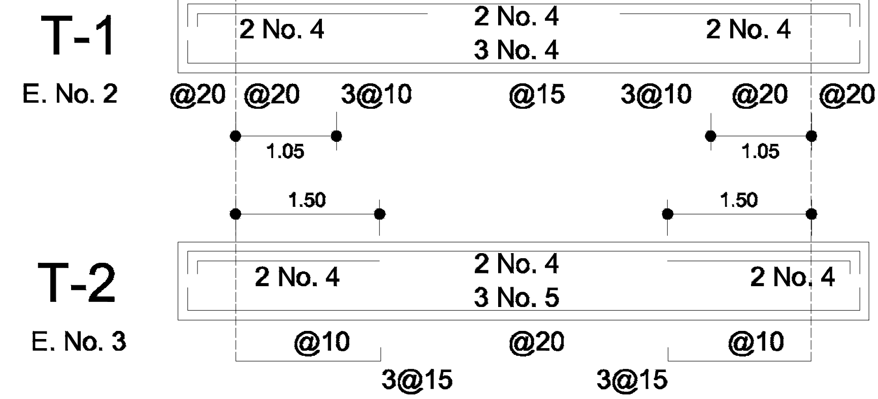
PLANTA, ARMADO LOSA DE AZOTEA ESC. 1:40
